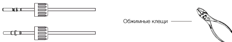
Рис. 5.4 Обжатие контактного вывода
