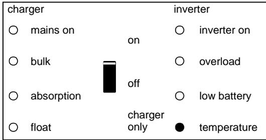
Инвертор выключен из-за чрезмерно высокой внутренней температуры
