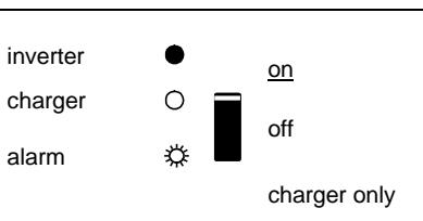
Инвертор включен и питает нагрузки.
