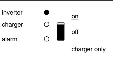
Инвертор включен и питает нагрузки.
