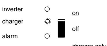
Входное напряжение AC переключается и зарядное устройство работает в плавающем режиме.
